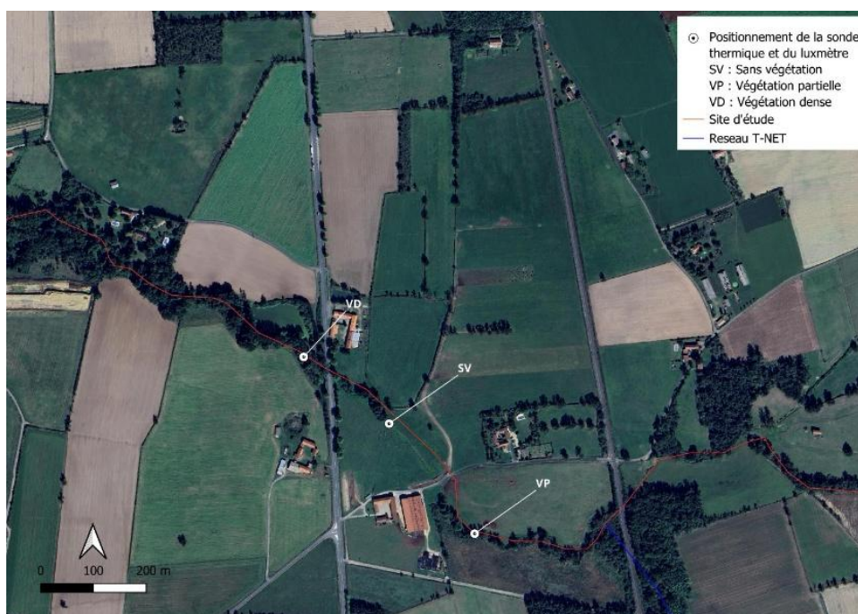
Figure 10 : Site du Garollet, affluent en rive droite de la Loire, avec la localisation des trois points de mesure. Chaque point est équipé d'une sonde conductimètre (température de l'eau), d'un luxmètre (luminosité) et d'un capteur de température de l'air. Les emplacements sont répartis selon la structure de la végétation : VD (végétation dense), VP (végétation partielle) et SV (sans
