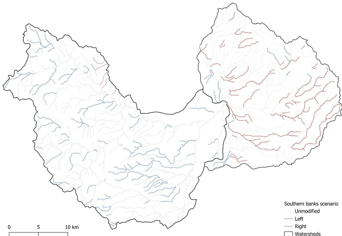
Figure 20 : Localisation des tronçons sélectionnés pour le scénario de restauration de la végétation ciblant les rives sud. Les tronçons ont été identifiés à partir du réseau T-NET en considérant une orientation comprise entre 22.5° et 157.5°C pour les rives droites, et comprise 202.5 et 337.5°C, pour les rives gauches. Seuls les tronçons présentant une densité de végétation initiale inférieure à 60% dans le modèle T-NET ont été retenus.
